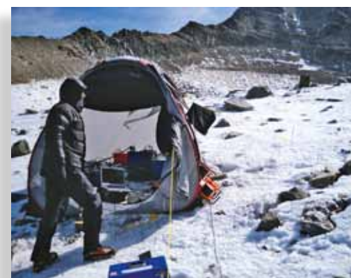
La tente de mesure du laboratoire LTHE protège 150 kilos de matériel scientifique piloté par ordinateur et relié à un câble électrique déployé sur la glace selon un carré de 80 x 80 mètres. Un sondage géophysique se déroule sur une journée au même endroit, puis le câble est déplacé de 40 mètres.
